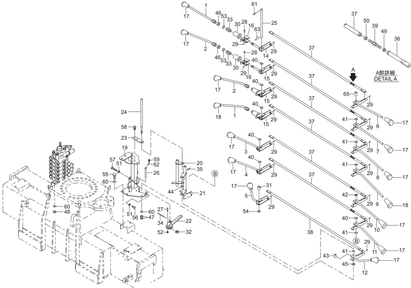
Fig. 16-1 コントロール組立 CONTROL ASS'Y
