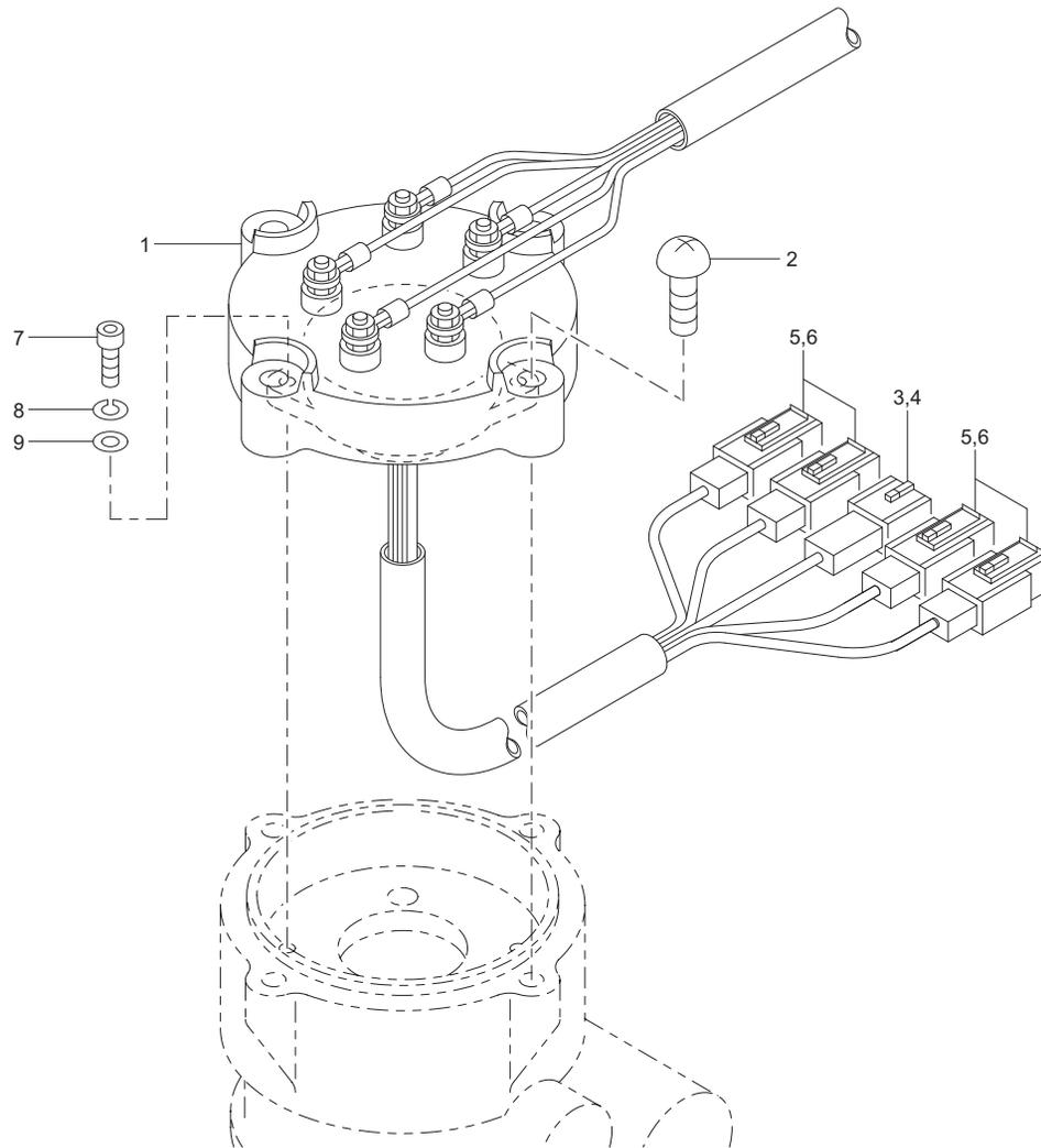
Fig. 15-1 スリップリング組立 SLIP RING ASS'Y
