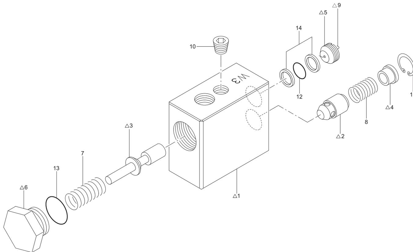
Fig. 12-1-1 カウンタバランスバルブ組立 (CB-03ED-W)
