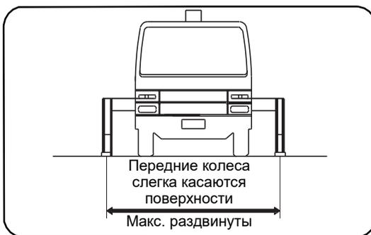
**9** При установке аутригеров не допускайте отрыва передних колёс крана-манипулятора от опорной поверхности.
