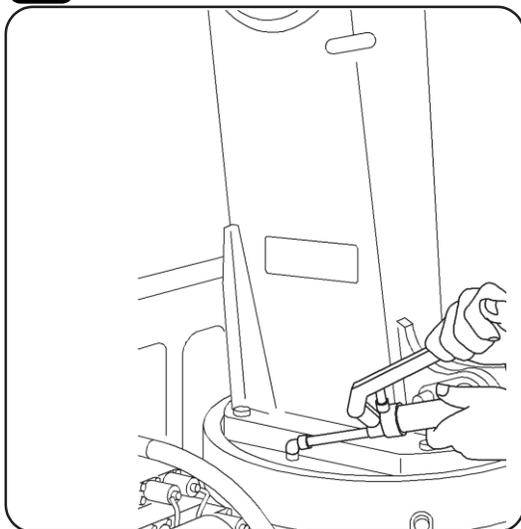
Своевременная смазка узлов и механизмов обеспечивает долговременную и безаварийную работу КМУ и должна проводиться в соответствии с таблицей смазки.
