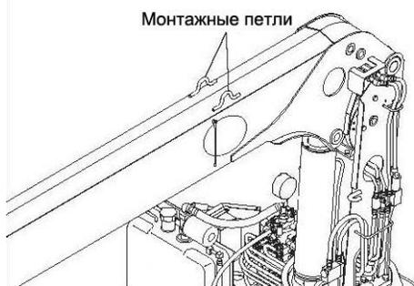
Монтажные петли установленные в верхней части стрелы предназначены для проведения монтажных и демонтажных работ стрелы в сервисных центрах UNIC. Запрещается использовать данные петли не по назначению
