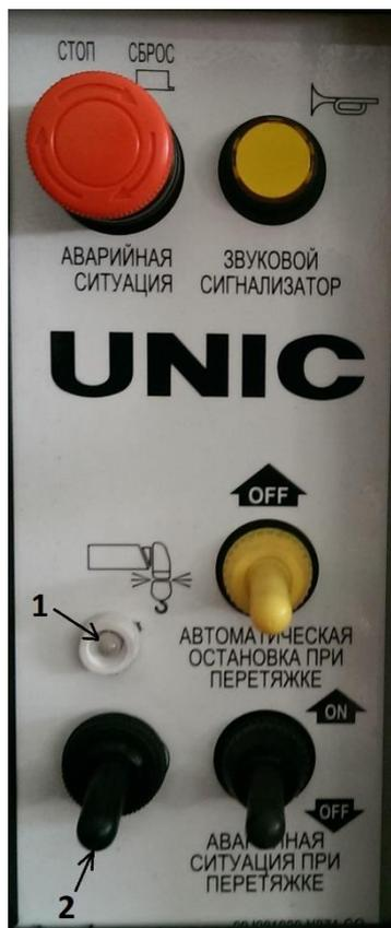
1. При температуре окружающей среды не ниже  $-20^{\circ}\text{C}$  и при температуре гидравлического масла в баке ниже  $+80^{\circ}\text{C}$ , светодиодный индикатор (1) светится зелёным цветом. Это штатный режим работы КМУ.
