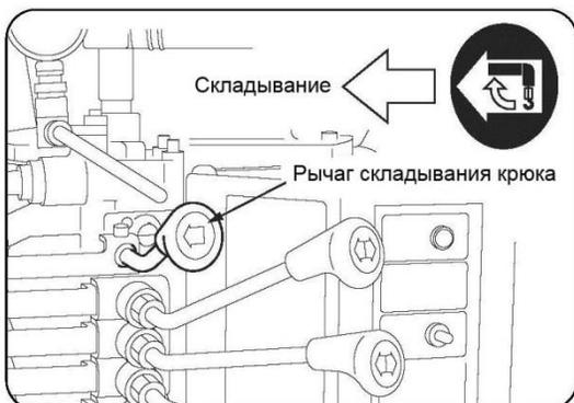
2 Медленно поднимите крюк с помощью рычага складывания крюка.
