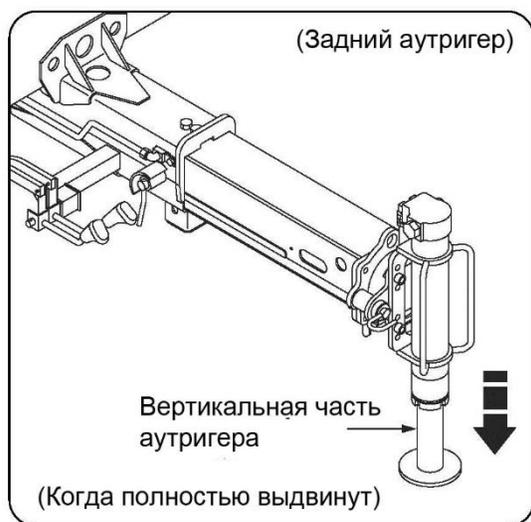
**6** Отрегулируйте с помощью аутригеров положение крана - манипулятора так, чтобы он стоял ровно и колёса были приподняты над опорной поверхностью.
