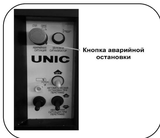
Предназначена для аварийной остановки работы КМУ. При ее нажатии она фиксируется в нажатом состоянии и останавливаются все операции КМУ.
