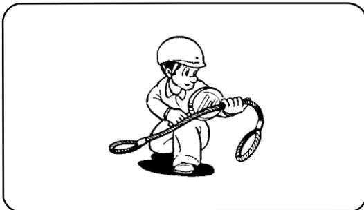
**2** Перед началом работы проведите проверку КМУ и строповочных приспособлений.
