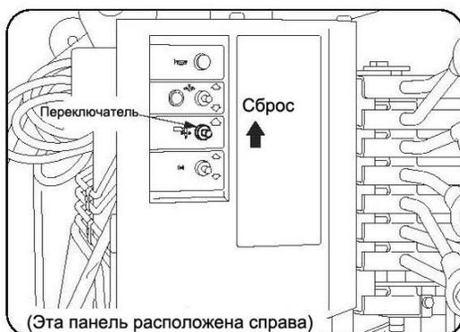
◆2. Действия при неисправности автоматической остановки подъёма крюка
